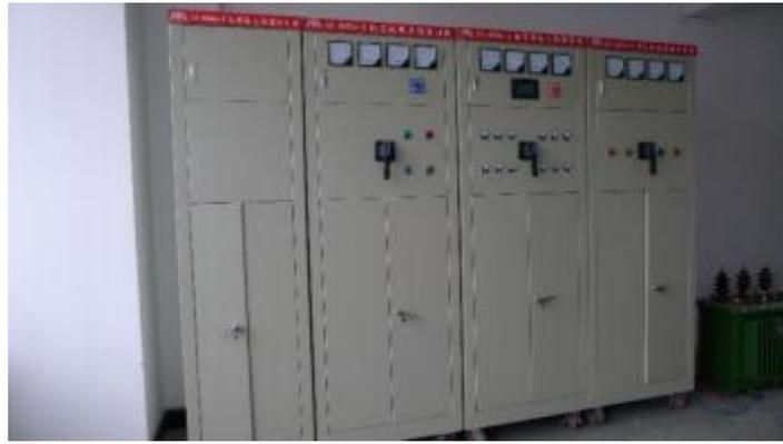
电网供配电系统控制综合实验设备
