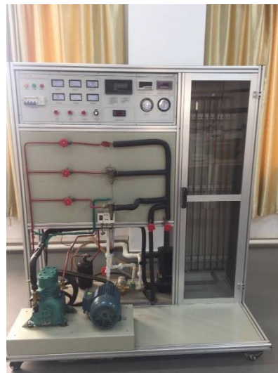
制冷机性能实验装置
